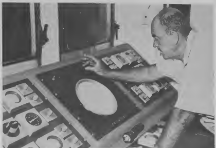
THE CONTROL center of the automatic positioning equipment aboard the floating rig Caldrill I. I is this control board which computerizes four outboard propellers. E CENTRO di control di e equipo cu ta tene posicion abordo di e barcu flotante cu ta bora, Caldrill I, ta e computador cual ta controlá cuater chapaleta di motor pafor di bordo.
